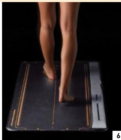
Tapis de mesure des pressions plantaires Win Track de Medicauteurs (31 Balma), 200hz, 12288 capteurs
